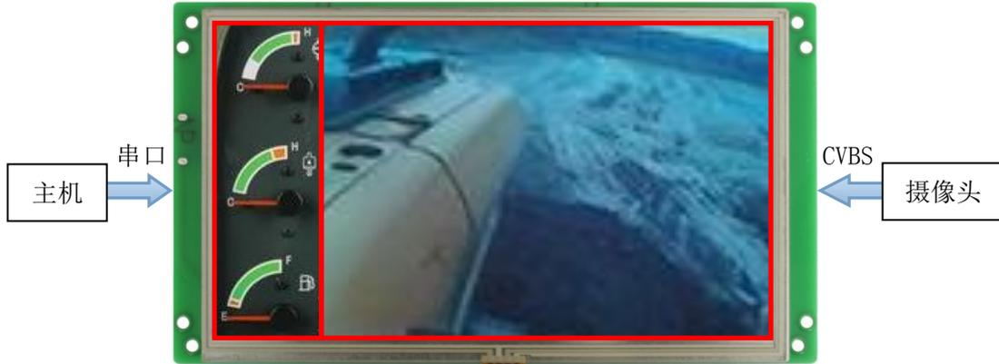
上图展示的是分区显示效果，显示屏左侧部分显示设备运行状态参数，右侧显示摄像头监控画面。监控画面的长宽大小和位置可以在摄像头控件中设置。设备运行状态参数利用表盘控件、变量控件、变量图标、动画图标等控件设计制作。
