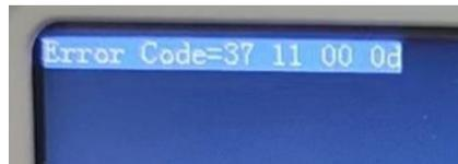
以错误代码“37 11 00 0d”为例，此信息提示第 55 号图标库里的 17 号图标异常，引起此异常的原因一般有以下两种：
